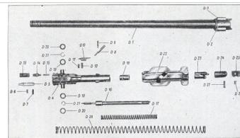
MG 34, Einzelteile: Lauf mit Verschluss
