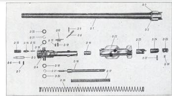
MG 34, Einzelteile: Lauf mit Verschluss
