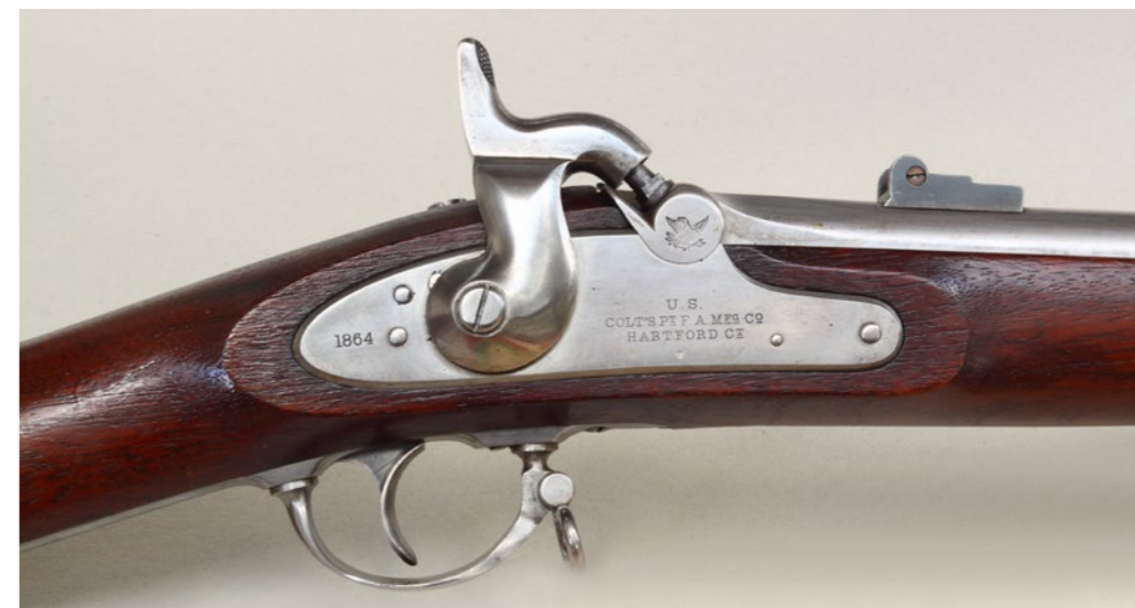
Ein typisches Perkussionsschloss einer Gewehrmuskete im Kaliber .58 (hier eine Fertigung der Firma Colt von 1864). Der Hahn liegt auf dem Piston, auf den vor dem Schuss ein Zündhütchen gesetzt wird. Dieses Modell, von verschiedenen Herstellern produziert, war ab Mitte des Krieges Standard bei den Infanterietruppen der nordstaatlichen Unions-Armee. Auch damit hatte die Vorderlader-Langwaffe ihren Höhepunkt erreicht. Mit Kriegsende Mitte des Jahres 1865 wurde sie obsolet, und man begann für eine kurze Zeit wenigstens eine geringe Menge zum Hinterlader umzubauen.
